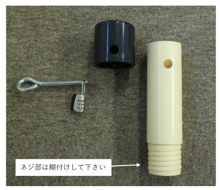
自記式水位計等、 各種孔内計測機器を 吊り下げられます。
